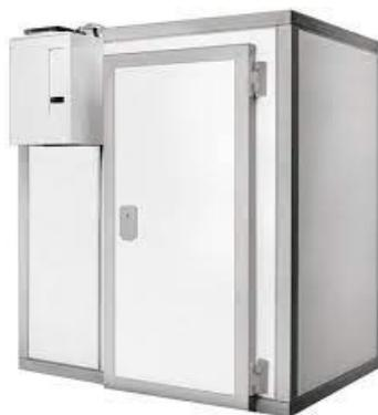
Это оборудование предназначено для хранения предварительно охлажденного пищевого сырья или готовых продуктов при низких температурах (-20...-15 °С). Холодильная камера, специализированная для низкотемпературного хранения, состоит из пенополиуретановых панелей с толщиной теплоизолирующего слоя 100 мм. Обе стороны панелей облицованы прочным полимерным покрытием. Камера оснащена моноблочным холодильным агрегатом Polair MB, который обеспечивает низкотемпературный режим хранения.
