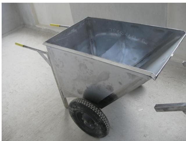
Тележка ковшовая "Рикша" предназначена для технологических внутрицеховых перемещений мясного сырья в мясоперерабатывающих цехах. Изготовлена полностью из высококачественной нержавеющей стали.
