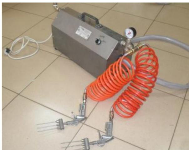
Инъектор для мяса ручной МИФ-ИР-05 осуществляет посол костного и бескостного кускового мяса-свинины, говядины, баранины, а также птицы и рыбы иглами. В комплект поставки входит насос с электроприводом, заборник рассола с фильтром и ручной инъектор с иглками 3 мм.
