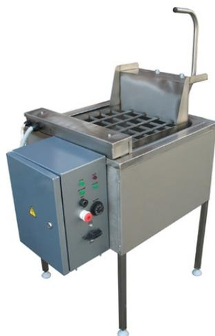
Данное оборудование предназначено для упаковки пищевых продуктов, предварительно упакованных в термоусадочную пленку, путем проведения процесса термоусадки. Конструктивно бланширователь представляет собой цельнотянутую ванну, закрепленную в прямоугольном каркасе и теплоизолированную с боковых сторон. В дне ванны установлены три трубчатых электронагревателя.
