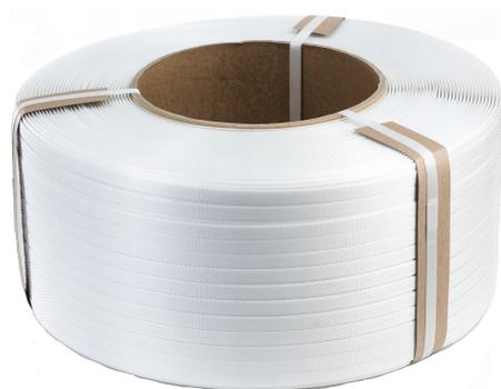
Упаковочная лента изготавливается из полипропиленовой гранулы путем экструзии, последующей вытяжки и закалки, является одним из популярных, современных упаковочных изделий. Применяется для обвязки различных грузов (всевозможные коробки, продукция мебельного производства, блоков, строительных материалов, пиломатериалы, металлопрокат, кирпич и тротуарная плитка на поддонах, печатной продукции, бытовой техники и т.п.).
