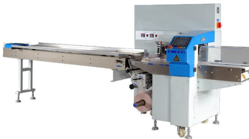
**Серия упаковочных машин Unipack- XSE** оборудована двумя серводвигателями для быстрой и удобной смены параметров настроек. Возможность сохранения 99 различных программ параметров упаковки. Горизонтальная упаковочная машина Unipack-XSE предназначена для формирования трехшовной упаковки («FlowPack») штучной или групповой продукции.
