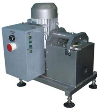
Оборудование предназначено для маркировки крышек, используемых для закрытия жестяных банок, толщиной от 0,22 до 0,25 мм и диаметром от 60 до 110 мм. Конструкция узла установки крышек для клеймения обеспечивает легкую и быструю настройку на крышки различных размеров и точное позиционирование клейма в центре крышки.
