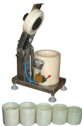
Это оборудование предназначено для укупорки стеклянных банок типа "Твист-Офф" вместимостью до 1000 мл, соответствующих ГОСТ 5717.2-2003 по размерам и форме. Процесс вакуумной укупорки банок "Твист-Офф" осуществляется после автоматического откачивания воздуха с помощью вакуумного насоса (поставляется отдельно и может быть Вакуумным насосом для машины укупорочной ИПКС-127В или аналогичным). Остаточное давление контролируется вакууметром, установленным на рабочей камере.
