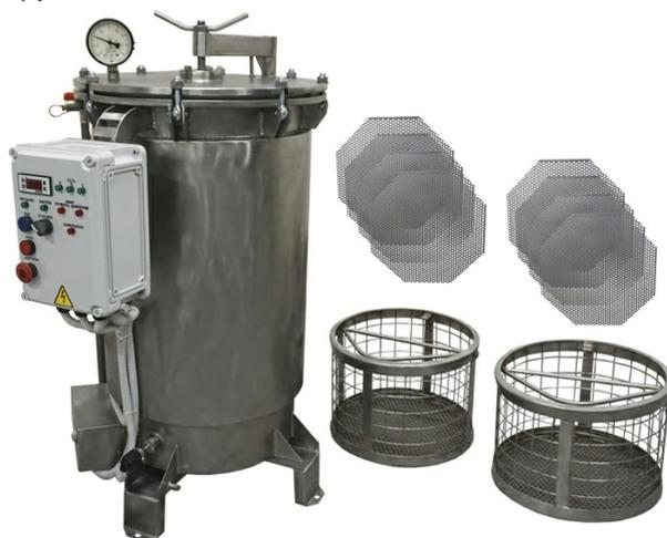
Автоклав предназначен для производства консервов - для стерилизации пищевых продуктов, а также для проведения исследовательских и лабораторных работ в сфере стерилизации пищевых продуктов. Используется для производства тушенки, рыбных и овощных консервов, в автоклаве можно проводить варку и стерилизацию очищенных овощей (картофеля, свеклы, моркови и т.п.) в специальной вакуумной упаковке. Продукт может быть расфасован в стеклянные и жестяные банки, реторт-пакеты, ламистерную тару.
