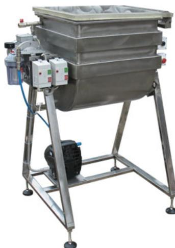
Это оборудование предназначено для перемешивания мясного фарша и других измельченных пищевых продуктов в условиях вакуума. Оно оснащено вымешивающим устройством лопастного типа, которое обеспечивает равномерное перемешивание продукта.
