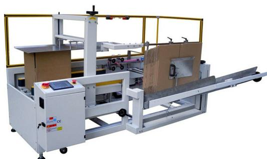
GPK-40H-18 является формовщиком коробов автоматического типа, который предназначен для формировки короба из заготовки и заклеивания его нижних створок. Управление работой формовщика осуществляется посредством ПЛК. Конструкция формовщика позволяет загружать заготовки без необходимости останавливать машину. Формовщик коробов GPK-40H-18 разработан специально для длинных коробов.
