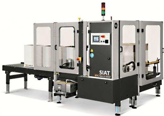
Серия F345 представляет собой высокоскоростные автоматические формовщики и заклейщики коробов с производительностью до 18 коробов в минуту. Производство компании Siat, Италия. Модели данной серии отличаются по размерам коробов, с которыми они работают. Данные машины формируют короба из стандартных заготовок и заклеивают нижние створки короба лентой скотч. Автоматический формовщик гофрокоробов F345 предназначен для интеграции в высокопроизводительные автоматические упаковочные линии.
