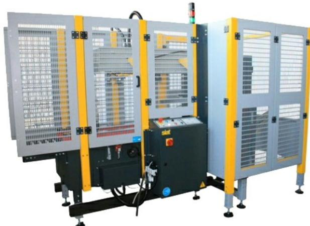
Модель F44 представляет собой автоматический формовщик и заклейщик коробов с производительностью до 10 коробов в минуту производства компании Siat, Италия. F44 формирует коробы из стандартных заготовок и заклеивает нижние створки короба лентой скотч. После заклейки короб готов к наполнению продукцией. Автоматический формовщик гофрокоробов F44 может использоваться как в полуавтоматических упаковочных линиях, так и встраиваться в автоматические линии.
