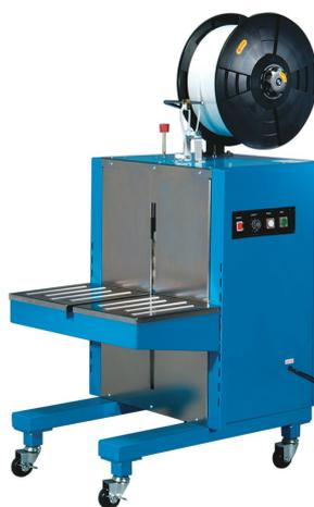
Полуавтоматическая стреппинг-машина TP-201Y - это стреппинг-система средней ценовой категории, которая может применяться для обвязки полипропиленовой (ПП) лентой упаковок небольших и средних размеров. Поскольку механизм сварки и натяжения расположен сбоку от рабочего стола и защищен от попадания мусора и строительных отходов, данная машина может успешно применяться на лесопилках, производстве кирпича, плитки, черепицы и др.
