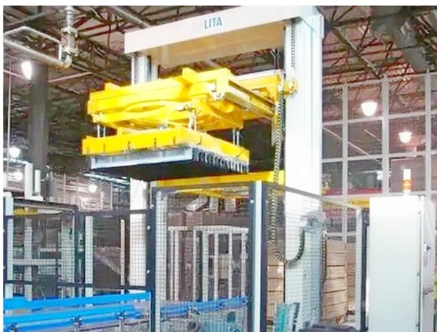
Модель VARIO представляет собой автоматический депаллетайзер с послойным захватом и переносом продукции на конвейер. Производство компании Lita srl, Италия. Продукция захватывается телескопической головкой при помощи пневматического давления с четырех сторон.
