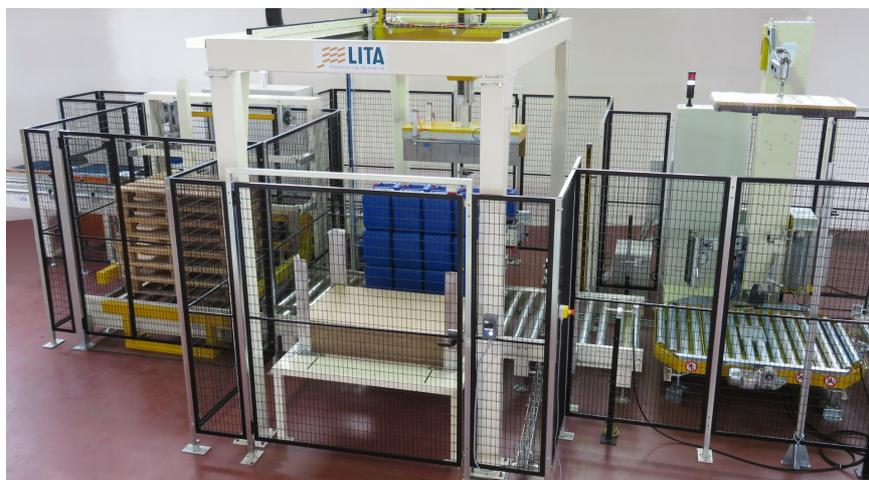
Модель ROBODUE представляет собой автоматический паллетайзер для укладки продукции с движением по трем осям. Производство итальянской компании Lita srl.
