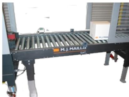
Приводной роликовый конвейер HD50M используется для передвижения коробов с продукцией шириной до 500 мм по производственной линии. Производство компании Siat, Италия. Это идеальный вариант для принудительной транспортировки продукции. Вы сможете выбрать необходимую длину конвейера: 2 м или 3 м. Ролики выполнены из нержавеющей стали.
