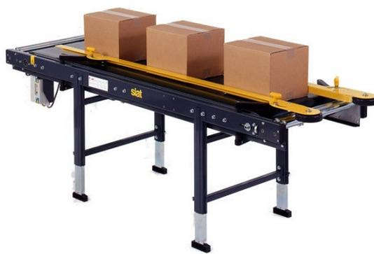
D90 представляет собой роликовый конвейер с диаметром ролика 48 мм производства компании Siat, Италия. Данный приводной конвейер используется для отвода продукции от упаковочных линий под углом 90°. Угол направления продукции меняется при помощи пневматического толкателя. Ролики изготовлены из оцинкованной стали. Конвейер D90 надежно стыкуется с производственной линией при помощи специальных креплений и идеально подгоняется к линии, благодаря телескопическим ножкам.
