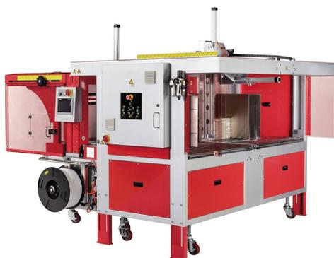
Автоматическая стреппинг машина TP-702CQ оснащена станцией для выравнивания связки гофрокартона с 4-х сторон. Задний упор, толкатель и боковые выравниватели обеспечивают идеальное выравнивание связки и ее целостность во время обвязки. Внести настройки размеров связки просто и не занимает много времени, что помогает сократить время простоя и делает производство более эффективным. Это действительно удобная и простая в управлении машина для вашей линии формовки коробов.
