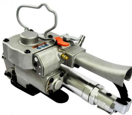
Модель автоматической компактной машинки XQD-НТ 13-19 относится к пневматическому обвязочному оборудованию. Работа на таких устройствах удобна тем, что для стреппинга не требуется наличие в шаговой доступности розетки. Да и не нужно прерывать работу на зарядку аккумулятора – требуется только наличие компрессора.
