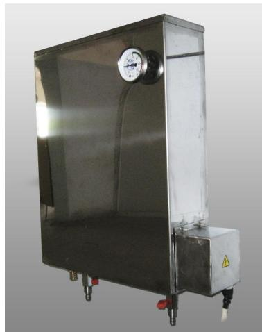
Стерилизатор для ножей СДН-20 предназначен для стерилизации (обеззараживания) ручного режущего инструмента — до 12 ножей и 1 муссата, на предприятиях мясоперерабатывающей, рыбоперерабатывающей промышленности, пищевых производствах где требуется производить очистку ножей от биологических и микробных загрязнений. В качестве обеззараживающей среды используется вода.
