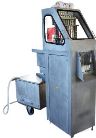
Автоматический инъектор ИПА-50.2 (50 игл, двойные) предназначен для посола способом инжекции рассольных и сложных растворов в кусковое мясное и рыбное сырьё при производстве колбас, деликатесов и прочего перед массированием и дозреванием. При использовании инъектора значительно увеличивается выход готовой продукции, ускоряется и улучшается качество посола сырья, а так-же значительно возрастают значения органолептических показателей и устойчивость к микробиологическим процессам.
