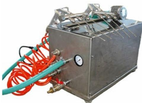
Инъектор ручной на 3 поста (ИР-2) предназначен для осуществления посола мясного, кускового сырья, птицы рыбы, путем введения рассольных растворов методом внутритканевой инъекции под давлением через иглы.
