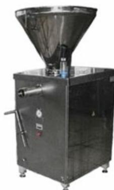
Шприц вакуумный ВШУ-1М с преобразователем частоты (регулировка оборотов), предназначен для вакуумирования мясного фарша и наполнения колбасных оболочек при выполнении технологической операции производства вареных и полукопченых колбас, сосисок, сарделек.
