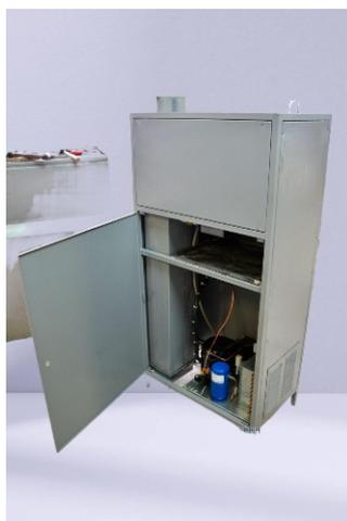
Охладитель дыма серии "ОДУ" предназначен для комплектования универсальных комплексов термодымовой обработки мясных и рыбных изделий функцией холодного копчения. Оборудование позволяет поддерживать оптимальный технологический режим термообработки. В качестве теплоносителя применяется "ледяная" вода, охлажденная во встроенном теплообменнике. Температура теплоносителя поддерживается автоматически. Комплектуется хладоагрегатом "Aspera".
