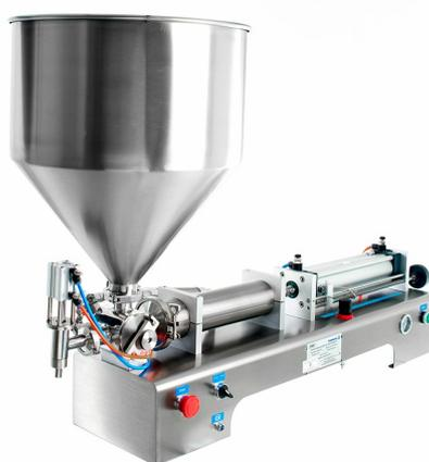
Дозатор поршневой G1WTD (100-1000 мл. 1гол., пастообразный) является полуавтоматическим поршневым дозатором. Используется для **заполнения пастообразных, жидких продуктов**. При эксплуатации данного оборудования Вы можете регулировать как **объем**, так и **скорость** заполнения продуктом.
