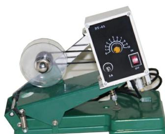
**Датер ручной DY-6A** – это малогабаритное устройство, используемое для проставления печатей на упаковке товаров. Прибор адаптирован для работы с разными материалами – алюминиевой фольгой, выделанной кожей, картоном, бумагой, полимерной пленкой, пластмассой и т.п. С его помощью можно указывать дату изготовления, срок годности, массу, номер партии, цену пищевых продуктов, напитков.
