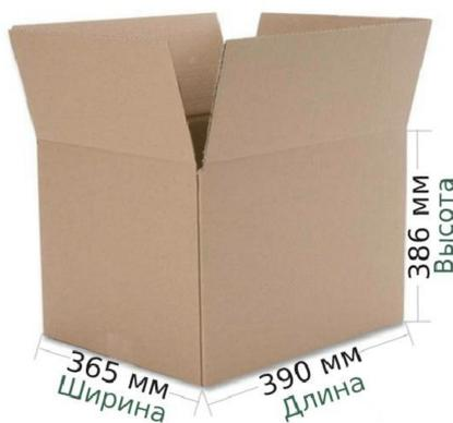
Пятислойная коробка с целлюлозой 390\*365\*386 мм П-32. Данная картонная коробка 390\*365\*386 мм состоит из 2-х гофрированных и 3-х плоских слоев. Марка П32 означает, что флютинги и внутренний слой состоят из бумаги, а 2 внешних слоя — из целлюлозы. Благодаря им увеличивается прочность и жесткость короба.
