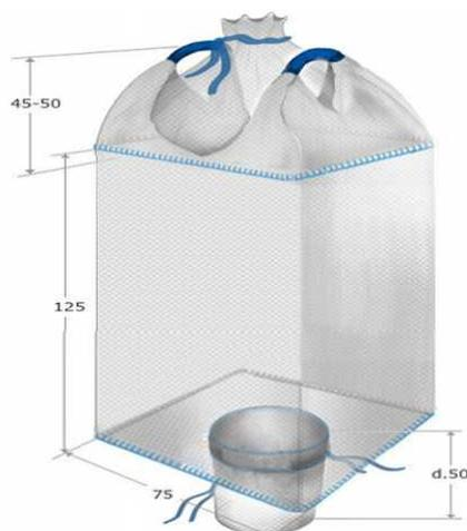
Биг бэг 75 x 75 x 125 см 2 стропы верх сборка - низ люк — 140 гр, - мягкий контейнер из плотного тканого полипропилена размером 75 x 75 x 125 см, рассчитанный на нагрузку до 1000 кг (1 т). Имеет 2 погрузочные стропы.
