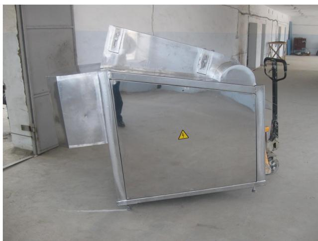
Блокорезка или роторный измельчитель мясных блоков ИБМ-2300, применяется для осуществления технологической операции по предварительному измельчению мясного сырья, поставляемого в блоках, максимального размера ДхШхВ до 800х517х305 (по требованию заказчика максимальные размеры могут быть увеличены) и температурой до -20 С°, на стружку и ломтики размером 100х100х10 (ориентировочно) для последующей технологической операции измельчения в "Волчке" или Куттере.
