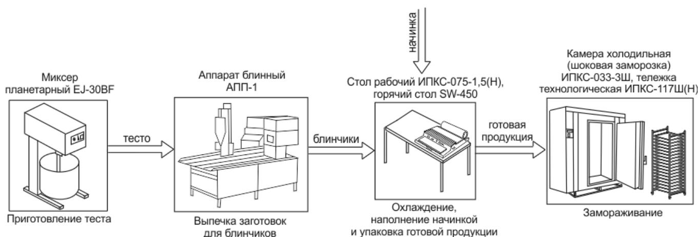
Это оборудование разработано для создания, замораживания и упаковки в полиэтиленовую пленку блинов с начинкой.
