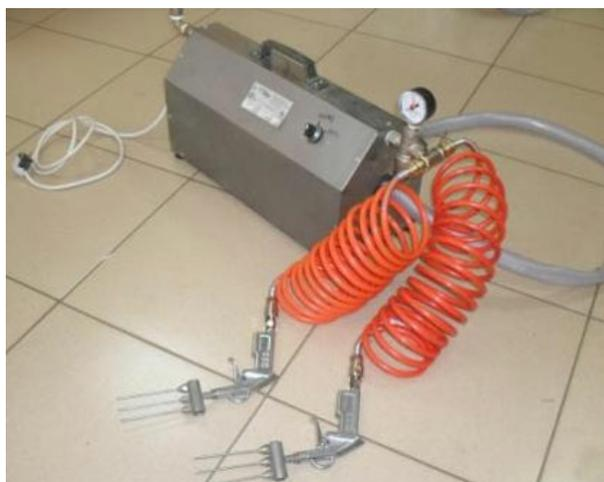
Инъектор снабжен клапаном который обеспечивает сброс давления в камере нагнетания при прекращении инъектирования. Это значительно увеличивает долговечность упругого нагнетающего ротора. Наличие двух заглушек дает возможности менять иглы на них ( 1-2 или 3 иглы) позволяет быстро и эффективно производить посол кускового мяса различных размеров
