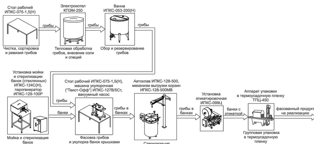
Это оборудование разработано для процесса соления и консервирования грибов в стеклянные банки с использованием крышек типа "Твист-Офф".
