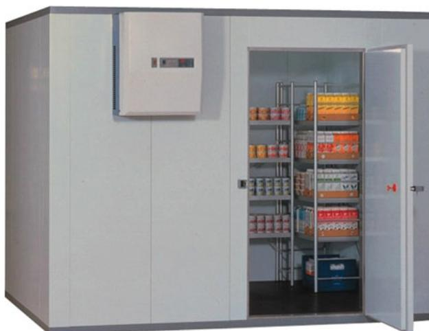
Это оборудование предназначено для хранения предварительно охлажденного пищевого сырья или готовых продуктов при средних температурах (-5...+10 °С). Холодильная камера, специализированная для среднетемпературного хранения, собрана из пенополиуретановых панелей с теплоизолирующим слоем толщиной 80 мм. Обе стороны панелей покрыты прочным полимерным материалом. Камера оснащена моноблочным холодильным агрегатом марки Polair MM, который обеспечивает среднетемпературный режим хранения.
