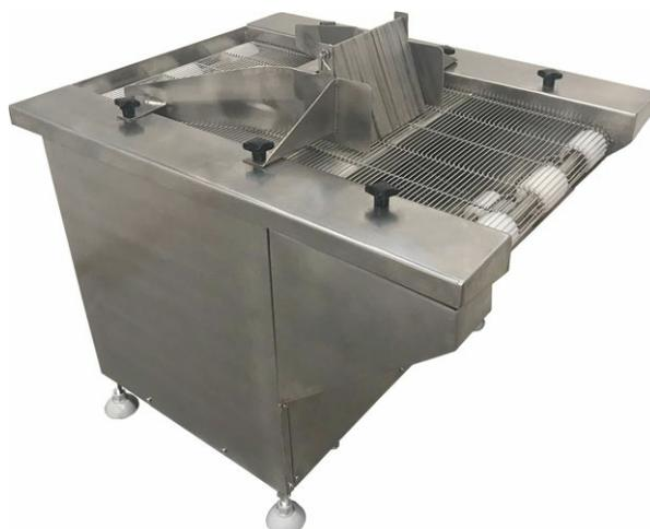
Машина панировочная предназначена для автоматической обсыпки панировочными сухарями полуфабрикатов из мясного, рыбного или овощного фарша. Применяется при производстве панированных котлет, а также наггетсов, филе, куриных крылышек, голеней, фастфуда в кляре и панировке.
