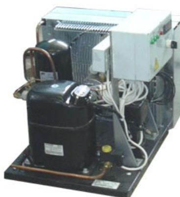
Это оборудование предназначено для охлаждения парного молока с использованием объемных охладителей. Тип холодильного агрегата - одноступенчатый компрессор, использующий фреон R22, и оснащенный воздушным конденсатором. Оно способно охлаждать продукты с начальной температурой +35°C и поддерживать температуру в охлаждаемых объемах в диапазоне от 0°C до -30°C. Это оборудование может быть использовано в закрытых помещениях с температурой до +35°C.
