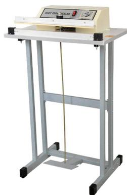
Ножной стационарный импульсный запайщик педального типа FRT-500 предназначен для запайки пакетов из различных термосвариваемых материалов с максимальной шириной горловины до 50 см. Может использоваться для упаковки пищевых и непищевых продуктов.
