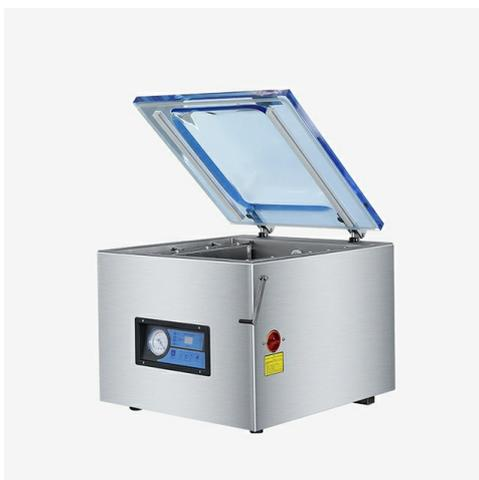
Однокамерный настольный вакуумный упаковщик HVC-410T/2A-G с функцией газонаполнения – одна из самых популярных моделей в линейке HVC. Выполнен полностью из нержавеющей стали (рабочая камера и корпус), укомплектован промышленным насосом с производительностью 20 м<sup>3</sup>/час. Аппарат достаточно компактный и требует минимум операционного пространства для работы.
