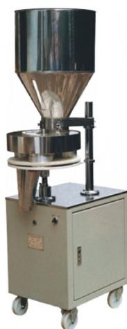
Объемно-ротационный дозатор предназначен для дозирования не пылящих порошков и гранулированных продуктов, специй, соли, сахара, бакалея, бытовая химия и т.д. Дозирование происходит за счет стаканов с изменяющимся объемом.
