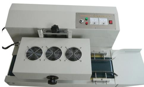
Модель LGYF-2000AX-I представляет серию промышленных индукционных запайщиков LGYF. Использует метод магнитной индукции для припайки специального полимерно-металлизированного вкладыша к горлышку пластиковой тары.
