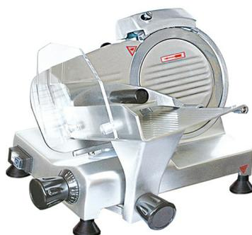
Гастрономический электрический слайсер VIATTO HBS-195JS предназначен для нарезки мяса, салями, ветчины, сыров и овощей ломтиками заданной толщины, благодаря чему сокращается время на подготовку холодных закусок. Оснащён встроенным заточивающим устройством, закреплённым на каретку.
