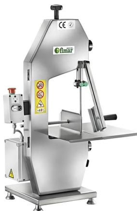
Ленточная пила FIMAR SE/2020A анодированная предназначена для нарезки на куски мяса и рыбы на предприятиях общественного питания и торговли. Оснащена микровыключателем, расположенным на крышке. Каркас изготовлен из анодированного алюминия, направляющая пилы и толкатель для мяса – из нержавеющей стали.
