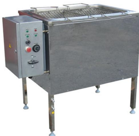
Данное оборудование предназначено для проведения тепловой обработки, включая бланширование и варку, различных продуктов, включая плодоовощную, мясную и рыбную продукцию. Для обеспечения удобства в работе, оно может быть оснащено двумя сетчатыми корзинами ИПКС-073-04-40(Н) вместимостью 37 литров каждая, а также приставкой ИПКС-073-07(Н), на которую можно установить корзины с продуктом, прошедшим термическую обработку, для стекания и сбора жидкости.
