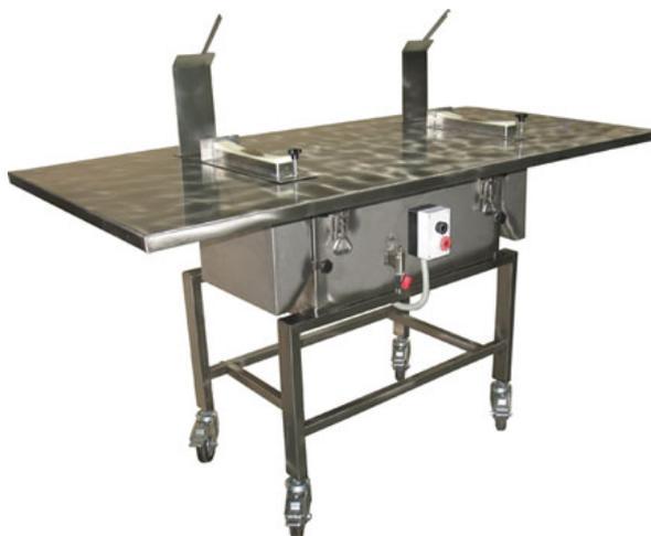
Это оборудование предназначено для разделки крабов - твёрдых частей тушек (панцирей) и клешней в пищевой промышленности. Машина для разделки крабов изготовлена из качественной пищевой нержавеющей стали.
