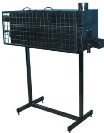
Это устройство разработано для процессов мойки и стерилизации пустых жестяных банок цилиндрической формы с внешним диаметром от 50 до 110 мм и высотой от 20 до 100 мм.
