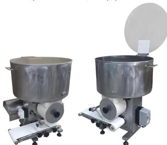
Бункер имеет съемную крышку из оргстекла, оснащенную устройством блокировки. Аппарат выполнен из пищевой нержавеющей стали.
