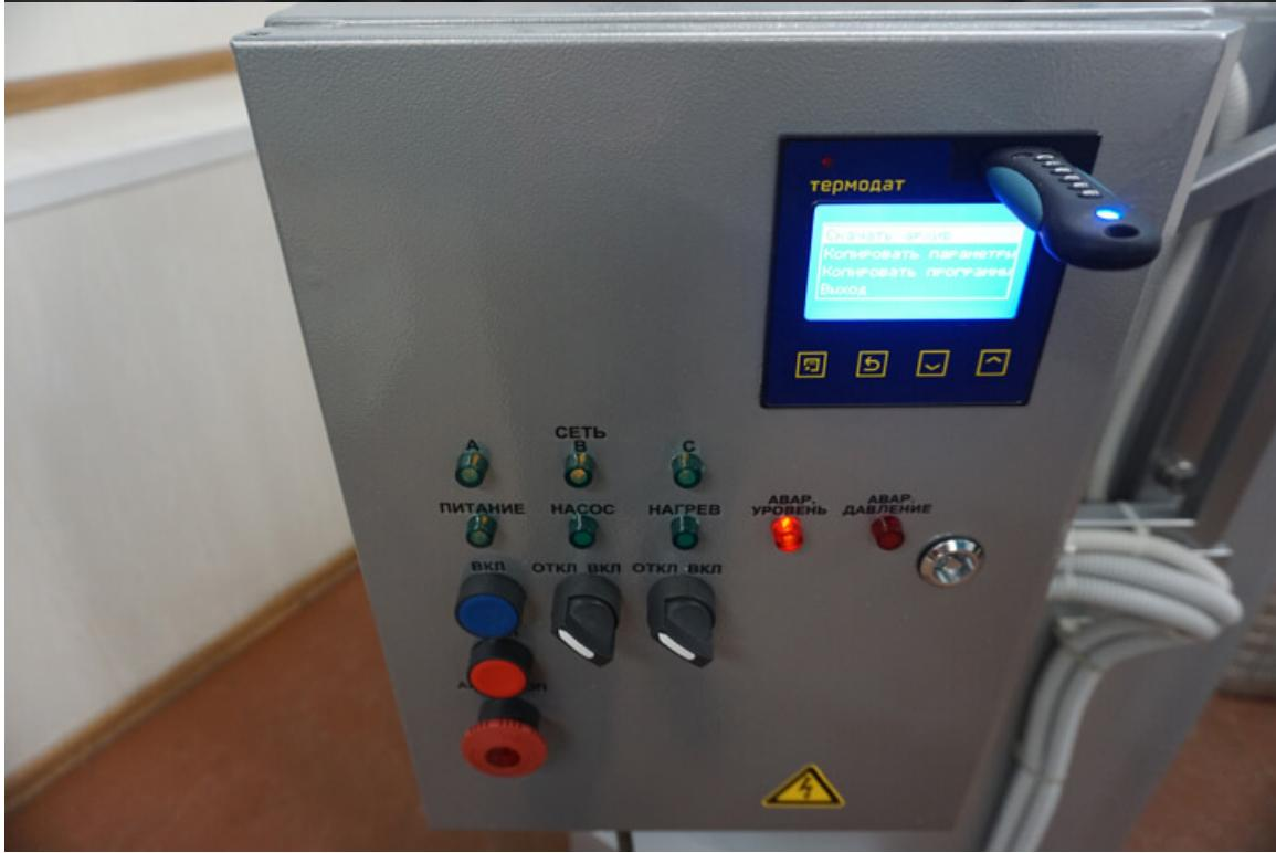
Наличие цифрового регистратора параметров техпроцесса с USB-интерфейсом
