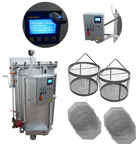
Автоклав выполнен из конструкционной стали с термостойким покрытием, входящие в состав две загрузочные корзины и восемь перфорированных полок для банок выполнены из пищевой нержавеющей стали.
