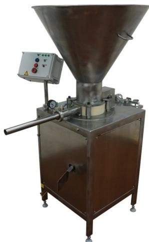
Данное оборудование предназначено для набивки сосисок, сарделек, колбас, а также для дозирования паштетов, колбасного сыра, творога и других однородных продуктов в синтетическую оболочку и подобные материалы. Вакуумный роторный колбасный шприц предназначен для порционного наполнения полимерных и натуральных оболочек фаршем или другими однородными продуктами, такими как паштеты, плавленый сыр, творог, джем и другие.
