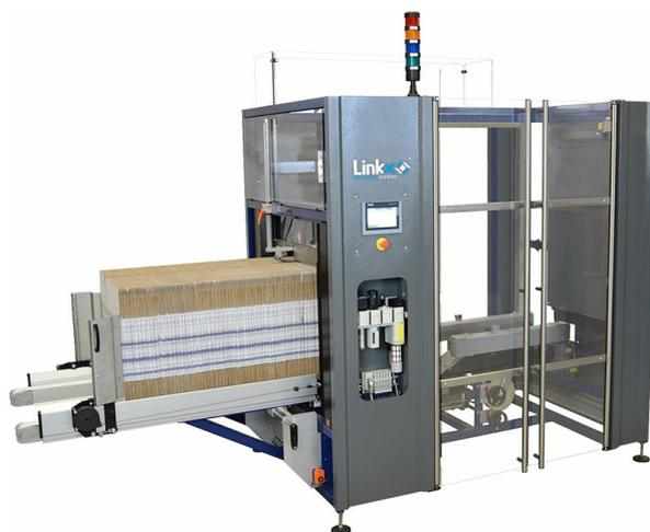
Формовщик коробов FEFCO 0200 и 0201 с прямым выходом заготовок по отношению к магазину заготовок. Благодаря этому настоящая модель занимает значительно меньше места, по сравнению с выходом под 90°.
